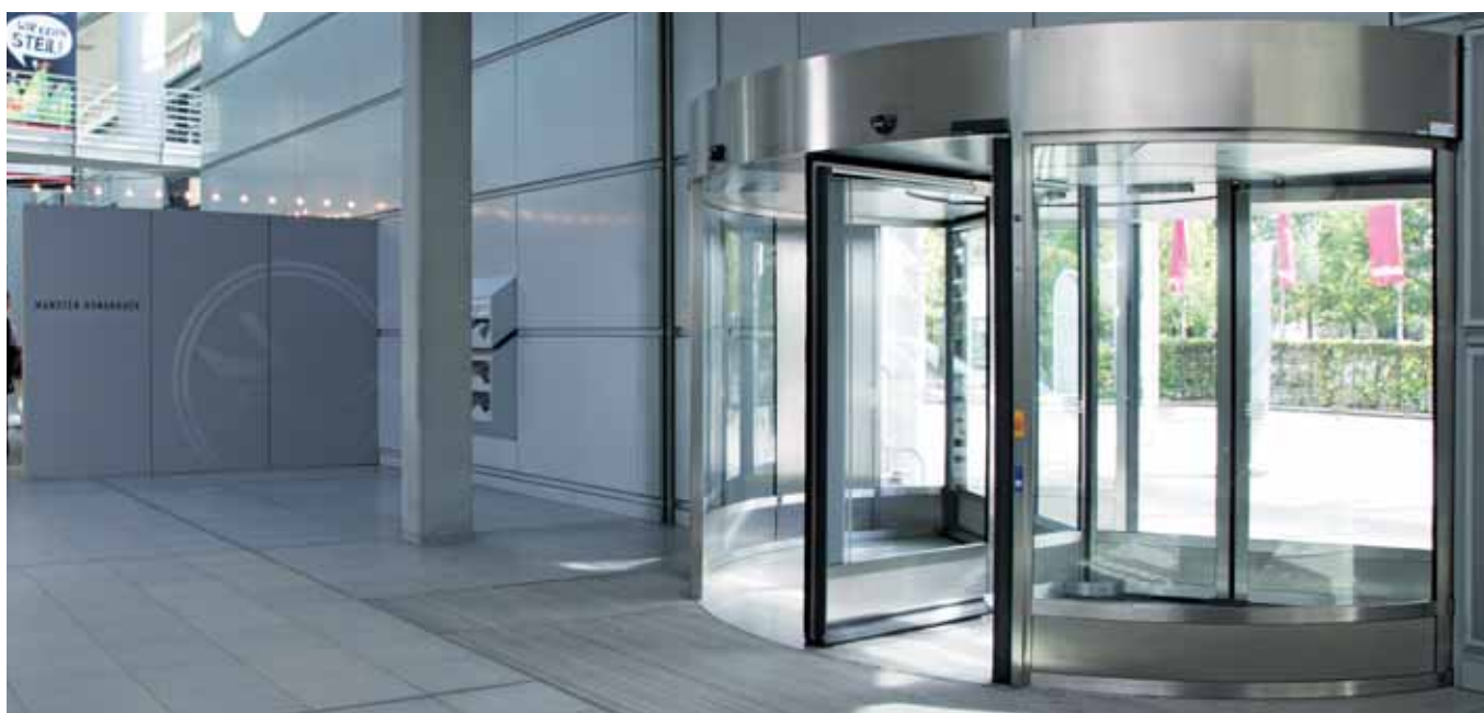
FLUGHAFEN MÜNSTER-OSNABRÜCK | GREVEN | Veľkokapacitné karuselové dvere GGR | plnoautomatické | 3-krídlové | opláštené ušľachtilou oceľou | krídla vyklapiteľné pre únikové a záchranárske cesty | ø 4800 mm
