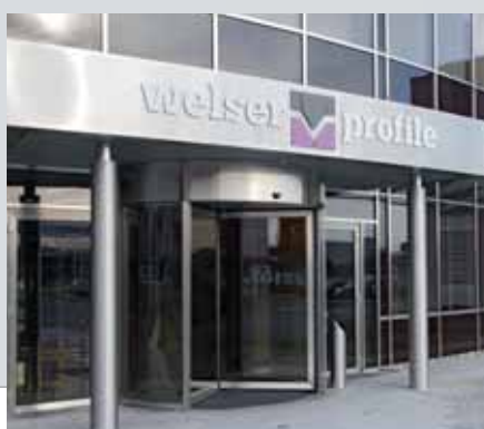
WELSER PROFILE GMBH | BÖNEN | Typ GRA | plnoautomatické | 4-krídlové | krídla vyklapiteľné pre letné otvorenie | opláštené ušľachtilou oceľou | ø 2780 mm
