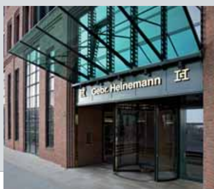
KONTORHAUS GEBR. HEINEMANN KG | HAMBURG | Typ GGG v špeciálnom prevedení | plnoautomatický | krídla dverí opláštěné titanizovanou ušľachtilou oceľou | zrkadlovo leštené | strop plechovej konštrukcie | ø 2860 mm
