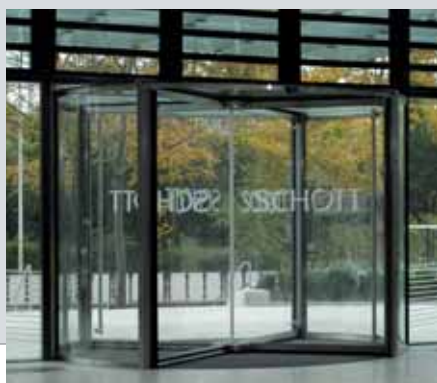
Schott AG | MAINZ | J • S • K Architekti | Typ GGG | plnoautomatické | 4-krídlové | opláštěné ušľachtilou oceľou | nočný uzáver | pohon skrytý v podlahe
