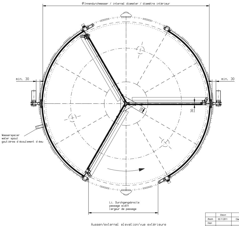
Bearb. 03.11.2011 Claes Standard Karusselltür GRA 3GV Standard revolving GRA 3GV Standard revolving GRA 3GV Porte tournante standard GRA 3GV Porte tournante standard GRA 3GV Zeichnung - Nr.
